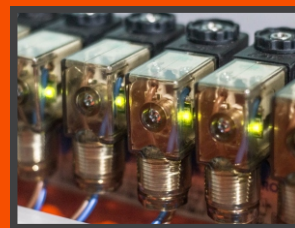
Conector eléctrico con led indicador.
